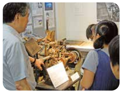
▲機械遺産に認定された活字鋳造機 (活字鋳造機とは…かつての新聞は金属製のはんこのような活字を組み合わせて印刷されており、その活字をつくる機械)
